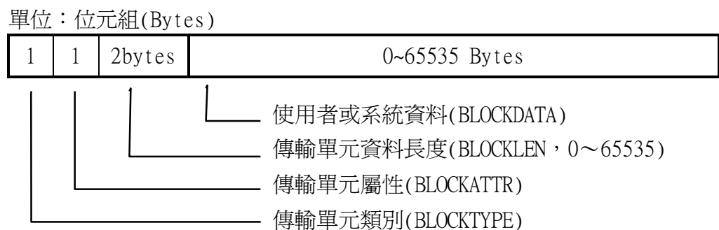
圖3.2.9 傳輸單元結構示意圖
